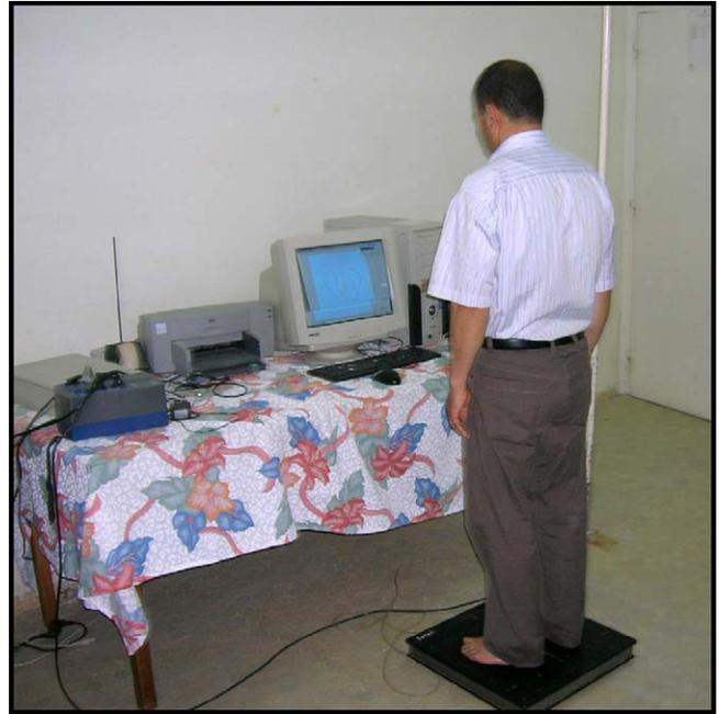
Fig. 1. Plateforme de force pour évaluation de l'équilibre statique.
