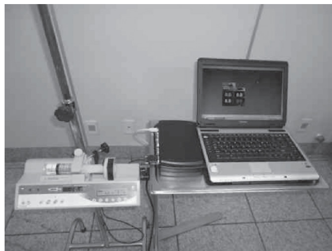
Figura 1 – Sistema de Infusão Alvo-Controlada de Propofol. Bomba de infusão, adaptador RS232 e Anestfusor.
