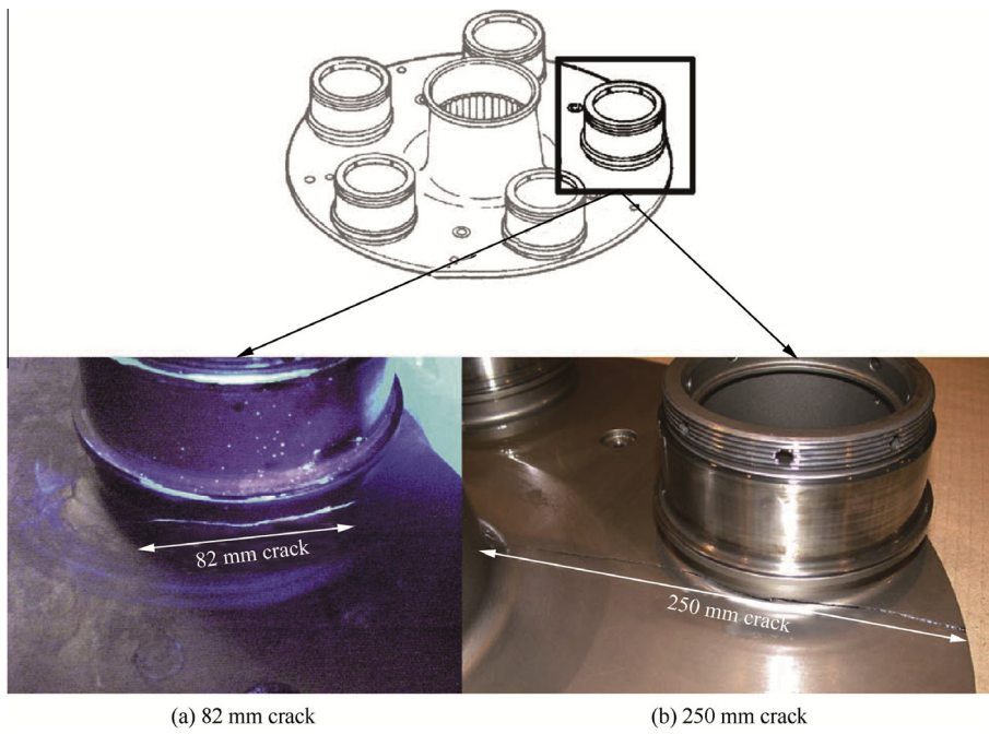
Fig. 4 UH-60A planet carrier: 82 and 250 mm cracks 1 (Courtesy of ELSEVIER).
