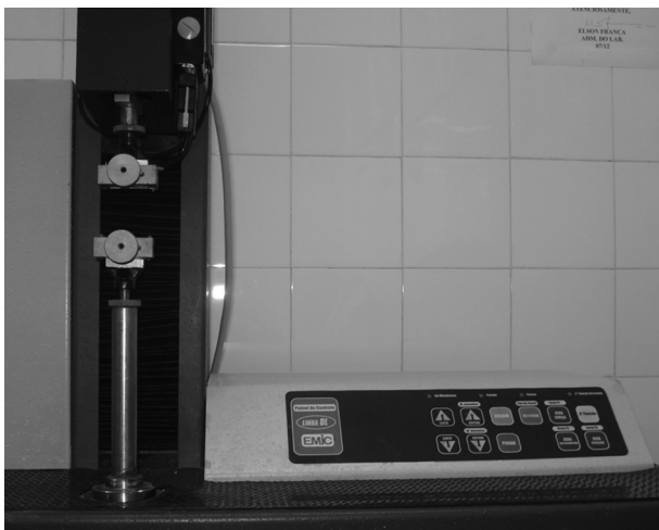
Figura 3 – Aparelho de teste de tração axial com célula de carga de 50N.
