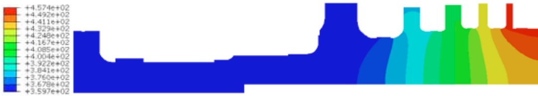
图 6. 启机稳定后转子整体温度分布
