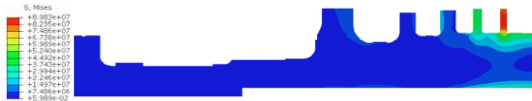
图 5. 应力峰值时转子整体热应力分布
