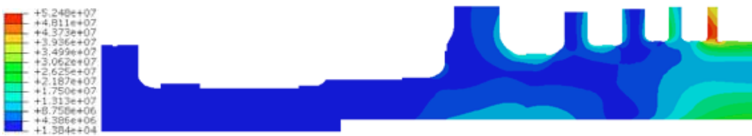
图 7. 启机稳定后转子整体热应力分布
