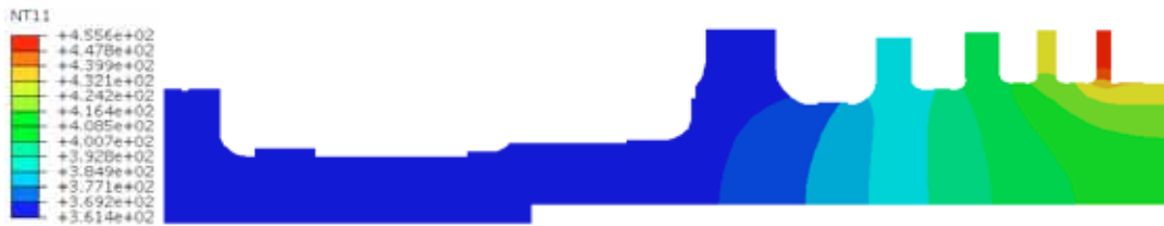
图 4. 应力峰值时转子整体温度分布
