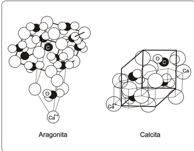
**Figura 1. Representaciones gráficas de los sistemas de cristalización de los principales polimorfos del carbonato de calcio (CaCO<sub>3</sub>). A la izquierda, la aragonita, el sistema ortorrómbico; y a la derecha, la calcita, cristalizando en el sistema rombohédrico (Modelo no a escala; modificado de la página del William Pengelly Cave Studies Trust Museum<sup>25</sup>).**
