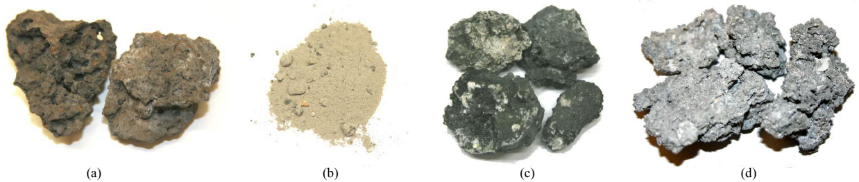
Fig. 1. (a) EAF slag; (b) LF slag; (c) APS; (d) AWD as-received samples
