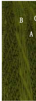
图 4 引晶段粗大柱状晶区的晶粒竞争形态
