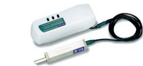
Fig. 2 : Handy surf E35 B Surface roughness tester
