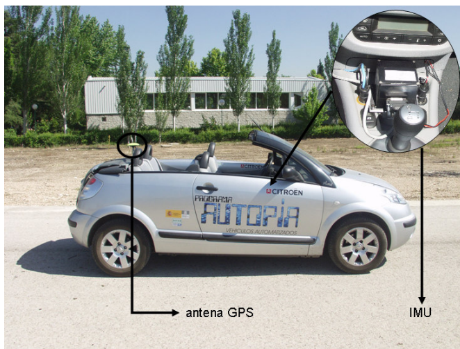
Figura 2. Citroën C3 Pluriel. Detalle de la ubicación del sistema de medida inercial y de la antena de recepción de la señal GPS.
