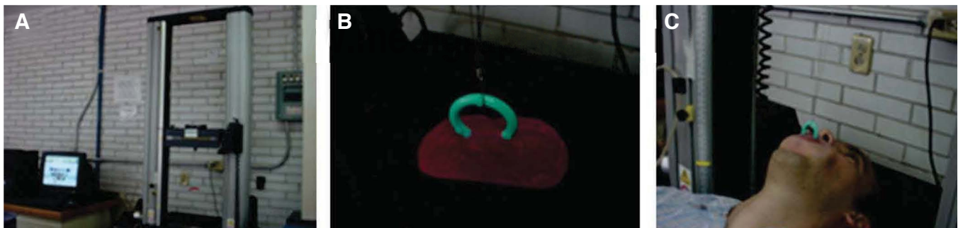
Figura 4. Prueba de tensión in vivo . A) Máquina universal de pruebas. B) Pantalla oral. C) Prueba de tensión.
