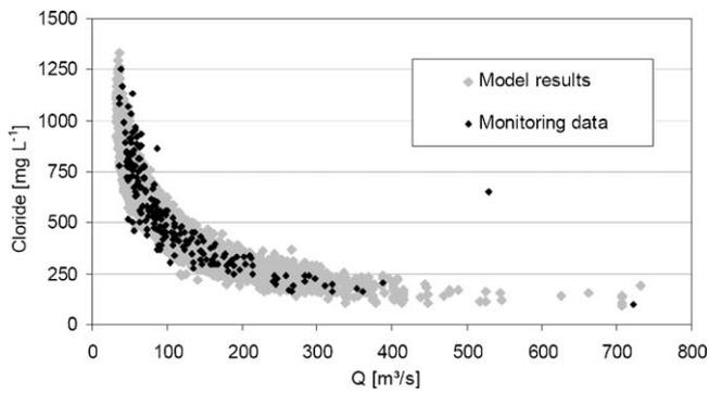
**Fig. 2.** Validation of a simulated 10y series of chloride concentration (Saale River, Groß Rosenberg) Monitoring datasets 1995–2005 from Landesbetrieb für Hochwasserschutz und Wasserwirtschaft Saxony-Anhalt, 2008.
