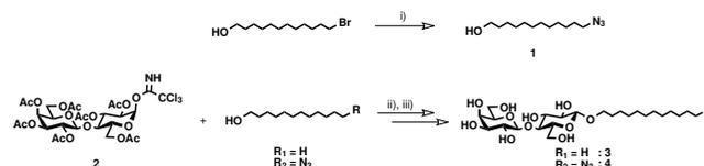
**Scheme 1:** Synthesis of amphipathic lactosides. i)  $\text{NaN}_3$ , DMSO,  $80^\circ\text{C}$ . ii)  $\text{BF}_3 \cdot \text{Et}_2\text{O}$ ,  $\text{ClCH}_2\text{CH}_2\text{Cl}$ ,  $0^\circ\text{C}$ . iii) NaOMe, MeOH, r.t.
