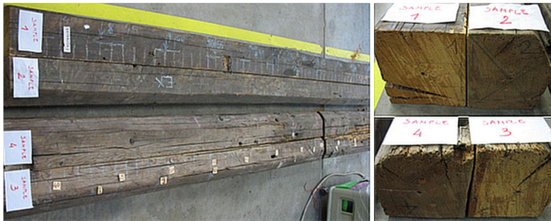
Fig. 2 Specimens cut from the spruce beam recovered from Prosperi-Sacratì palace ( left ), top and bottom parts of the obtained specimens ( right ) Abb. 2 Links: Entnahme der Prüfkörper aus den vom Prosperi-Sacratì-Palast stammenden Fichtenbalken, rechts: Prüfkörper aus dem oberen und unteren Bereich der Balken
