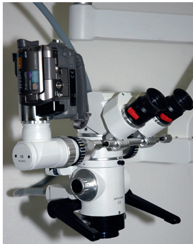
Figura 2 Microscopio operatorio con telecamera per ripresa video.
