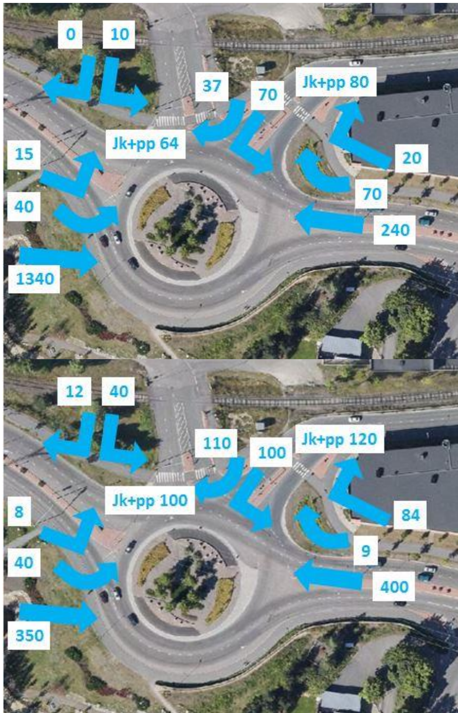
Kuva 21. Pallon liittymän 28.4.2016 käsinlasketut liikennemäärät aamu- ja iltahuippu- tunteina klo 7-8 (ylempi) sekä 16-17. (Kuva: Lappeenrannan kaupunki)
