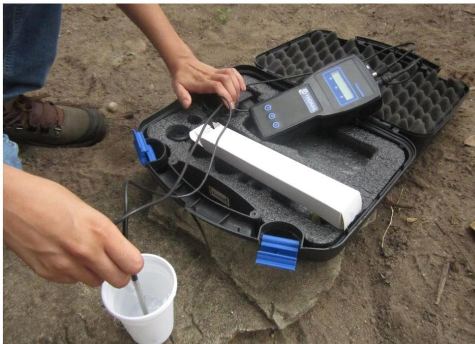
**Figura 1.2:** Realização em campo de medidas de CE, STD e T com o Condutivímetro Portátil Modelo – TEC-4P-MP. Fonte: Aryane Assunção.
