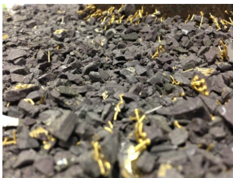
Figura 5 Microprocessori ceramici sottoposti a macinazione
