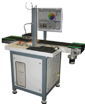
Figura 30 Sistema di acquisizione HSI con (a) ImSpectorTM N17 e (b) Piattaforma HSI
