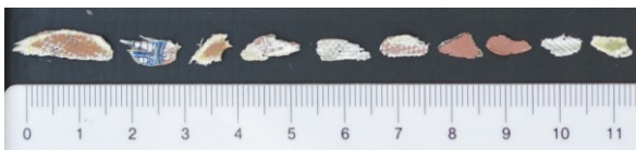
Figura 20 Classe granulometrica <4.2 mm, di una scheda elettronica di personal computer, sottoposta a macinazione
