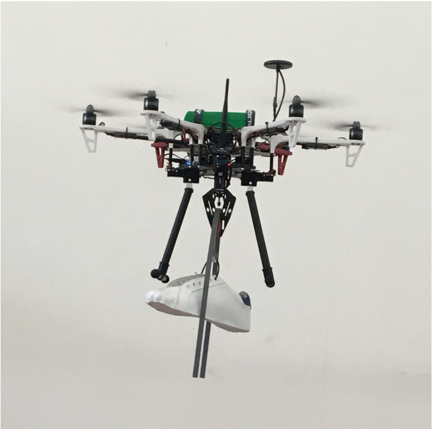
Figura 16 - Test di afferraggio, sollevamento e movimentazione di un oggetto di forma non regolare da parte di un drone
