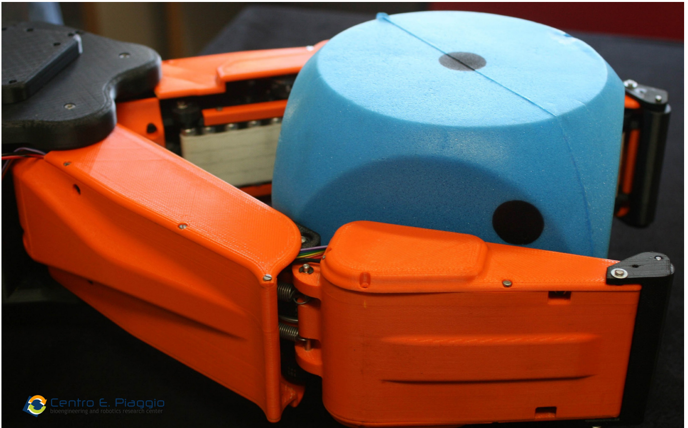
Figura 17 - Gripper a due dita in grado di afferrare oggetti diversi
