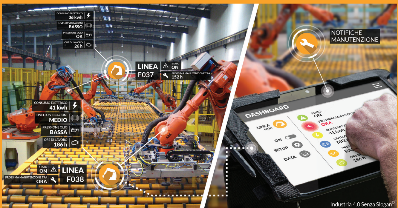
Figura 12 - Manutenzione basata sui dati pervenuti dai sensori sulla linea
