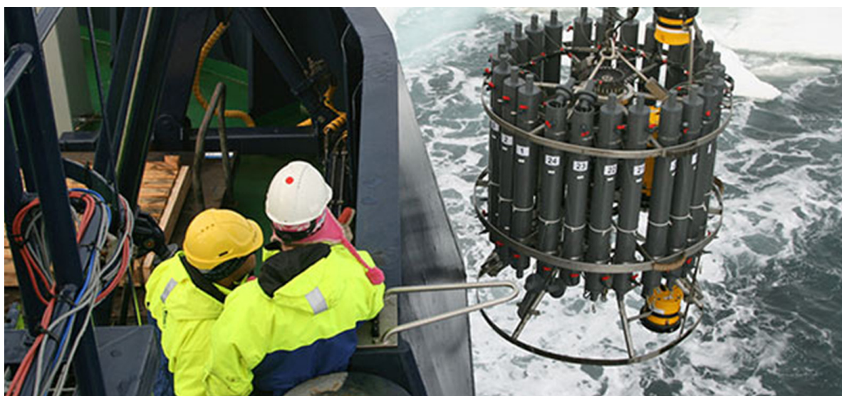
Рис. 2. CTD-зондирование с отбором проб воды (международная экспедиция SWERUS-3: июль–октябрь 2014 г.)
