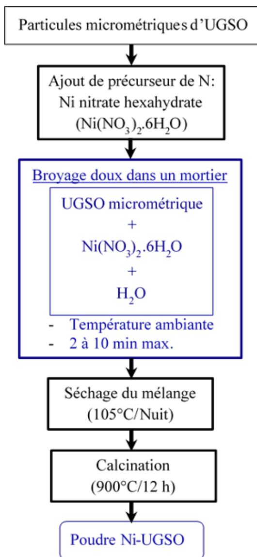
Figure 2.5 : Procédé de synthèse du nouveau catalyseur Ni-UGSO selon la méthode de la réaction à l'état solide améliorée
