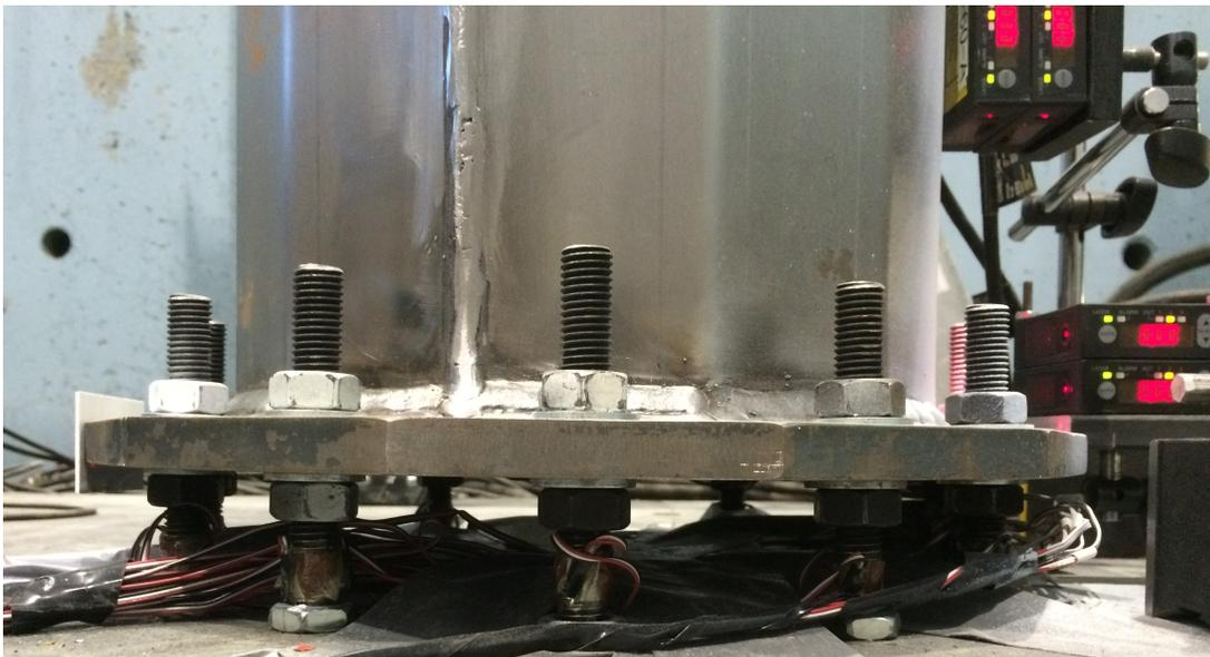
Figure 3.8 Encastrement des ancrages
