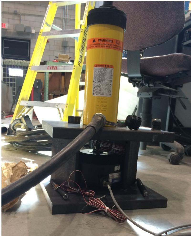
Figure G.2 Banc d'essai utilisé lors de la calibration des ancrages
