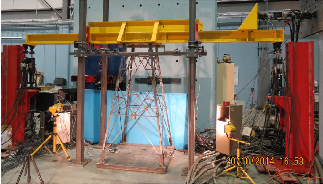
Figure 3.2 Station d'essai à trois degrés de liberté [Loignon *et al.*, 2016]
