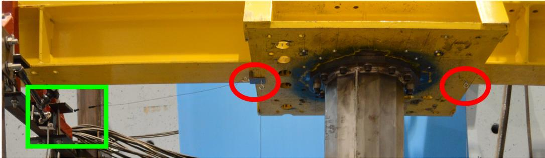
Figure 3.7 Position du potentiomètre horizontal et points d'attache des trois potentiomètres
