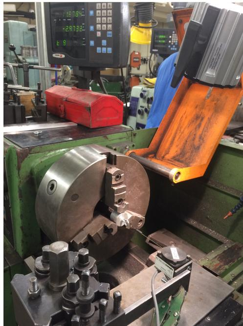
Figure F.1 Présentation du montage utilisé lors de la calibration des potentiomètres
