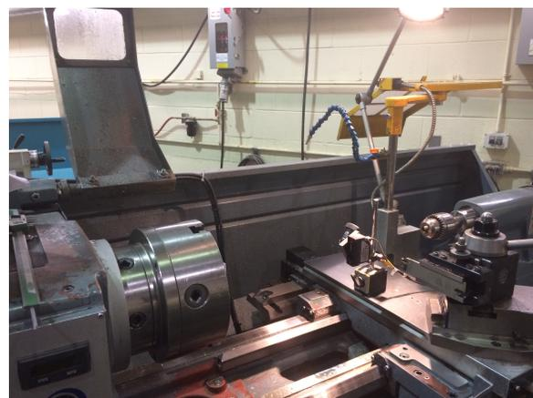
(b) Capteur installé sur le chariot du tour
