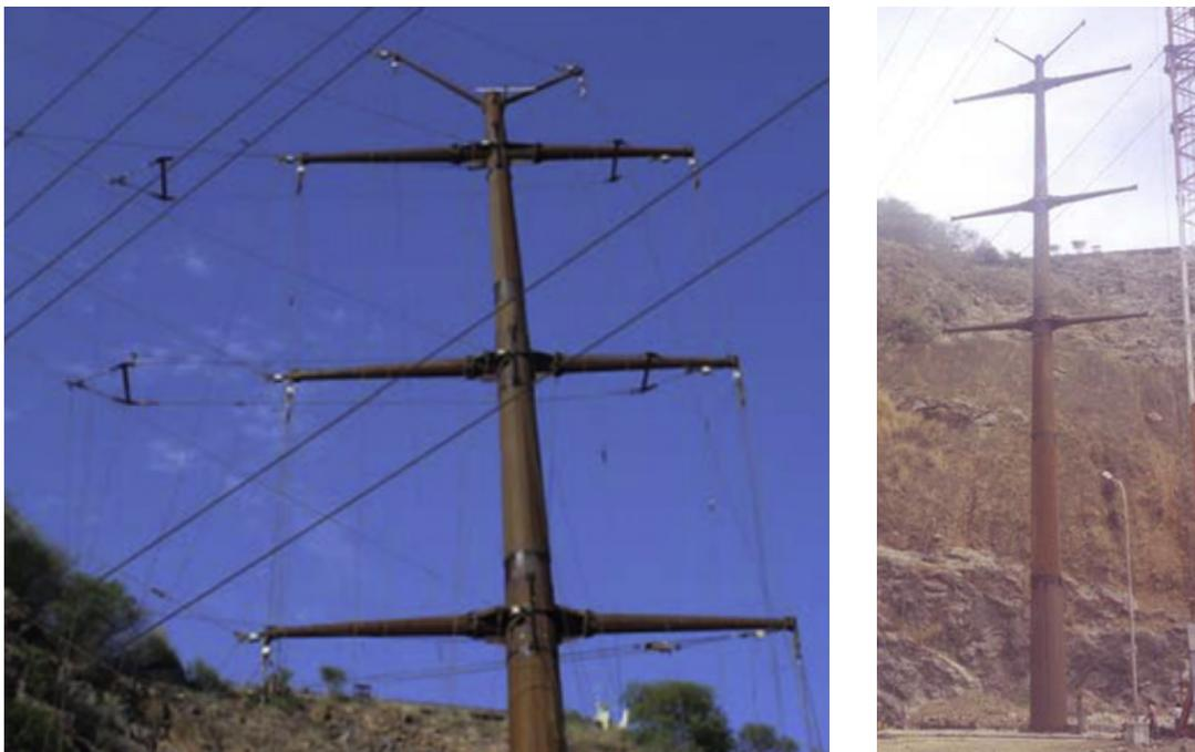
Figure 2.10 Essai à échelle réelle sur un pylône tubulaire biterne de 400 kV [Prasad Rao *et al.*, 2011]
