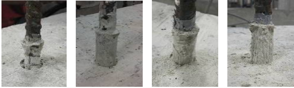
Figure E-4 Arrachement des ancrages pour différents temps de cure. Adhésif ARC.
