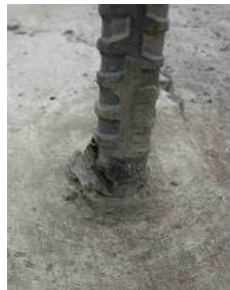
Groupe 1, #2 Groupe 2, #1 Groupe 2, #2 Groupe 3, #7 Figure E-9 Défaillance des ancrages sous chargement soutenu. Adhésif AAC - 23°C.
