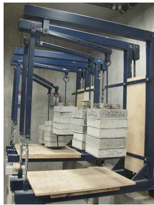
Figure E-6 Essais du chargement soutenu en cours. Adhésif AAC - 23°C.
