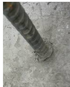
Groupe 1, #2 Groupe 2, #1 Groupe 2, #2 Groupe 3, #7 Figure E-9 Défaillance des ancrages sous chargement soutenu. Adhésif AAC - 23°C.
