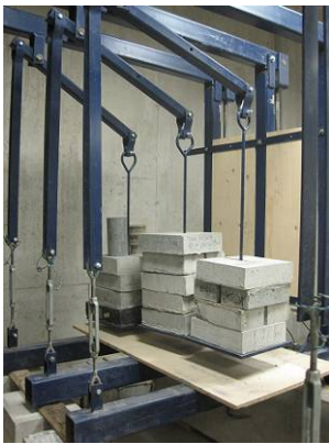
Figure E-6 Essais du chargement soutenu en cours. Adhésif AAC - 23°C.
