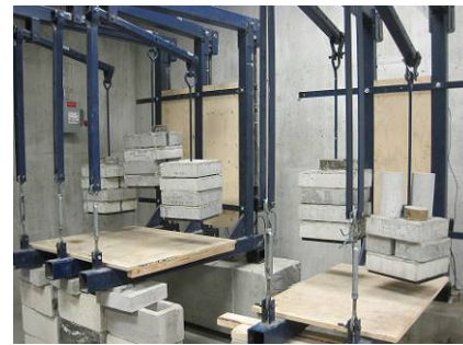
Figure E-6 Essais du chargement soutenu en cours. Adhésif AAC - 23°C.
