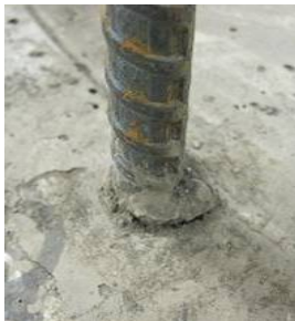
Groupe 1, #2 Groupe 2, #1 Groupe 2, #2 Groupe 3, #7 Figure E-9 Défaillance des ancrages sous chargement soutenu. Adhésif AAC - 23°C.
