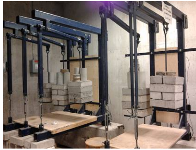
Groupe 5 - 60% et 70% N_{adh} Figure E-7 Essais du chargement soutenu en cours. Adhésif ARC – 23°C.
