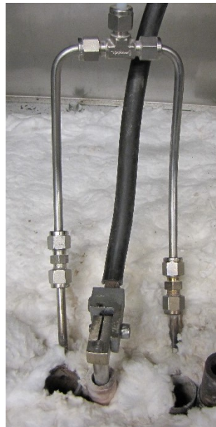
Figure A.12 Fixation des tuyaux de refroidissement.
