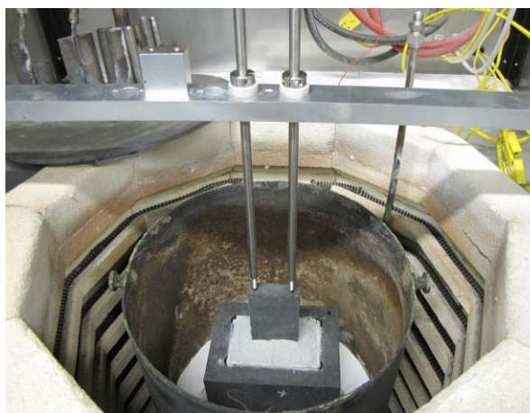
Figure A.9 Positionnement de la cellule à l'aide des tiges de contact électrique.
