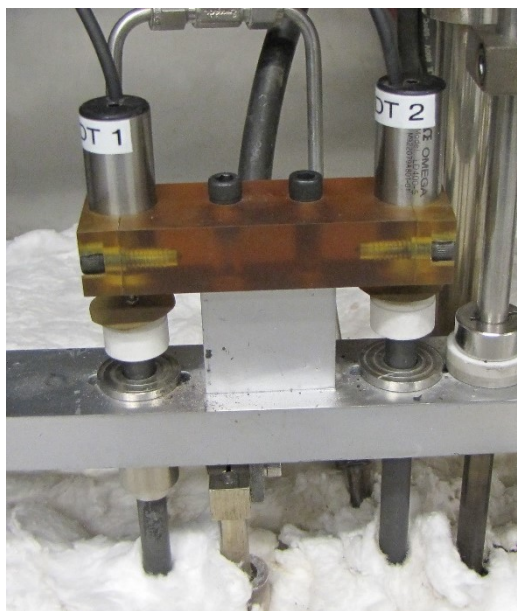
Figure A.16 Installation des LVDT.
