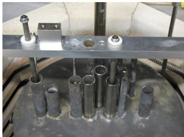
Figure A.8 Positionnement du porte-creuset.
