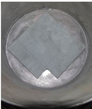
Figure A.4 Plaque de carbure de silicium déposée.
