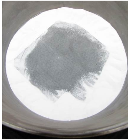
Figure A.5 Alumine déposée autour de la plaque de carbure de silicium.
