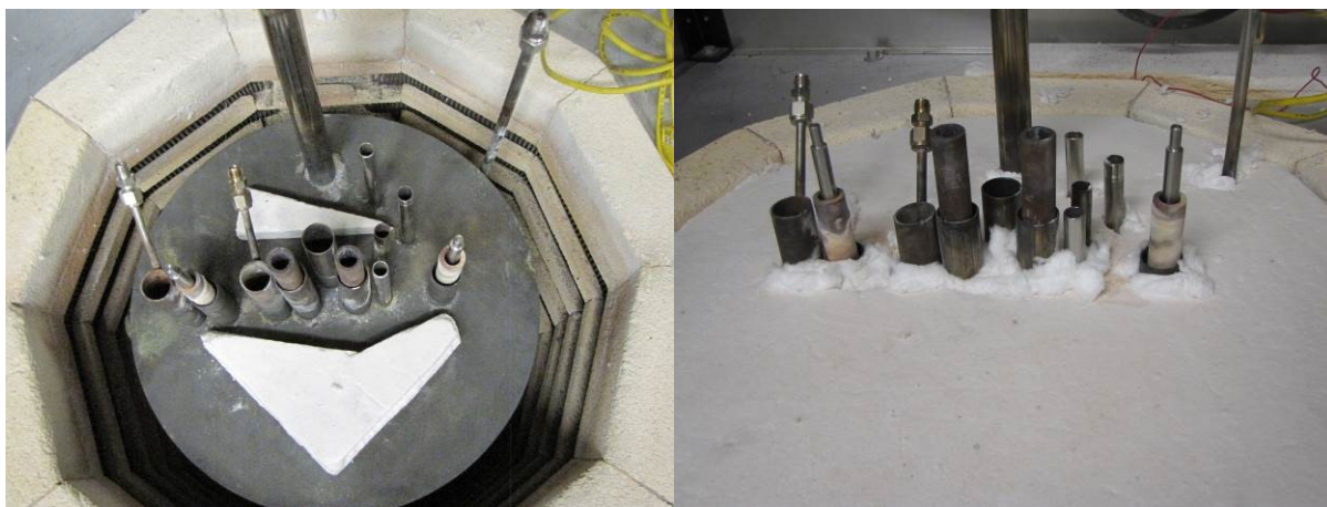
Figure A.10 Blocs d'appui et isolation des ouvertures.
