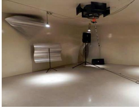
Figure 1.8 : Chambre réverbérante du la laboratoire GAUS de l'université de Sherbrooke
