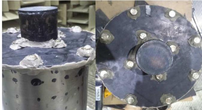
Figure 4.9 : Utilisation du Mastic pour limiter les fuites du bruit
