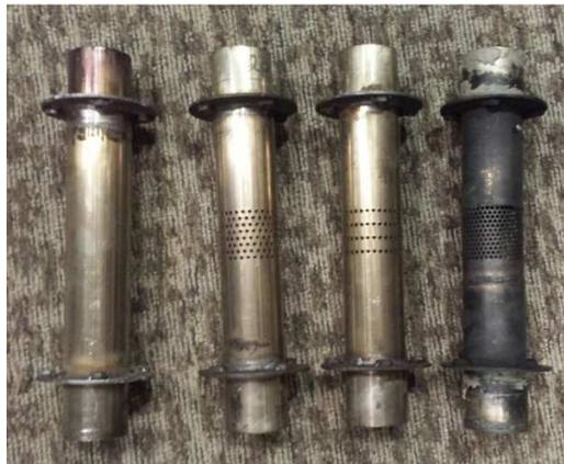
Figure 5.1 : les tubes perforés de différents taux de perforations, longueur de perforation 50 mm
