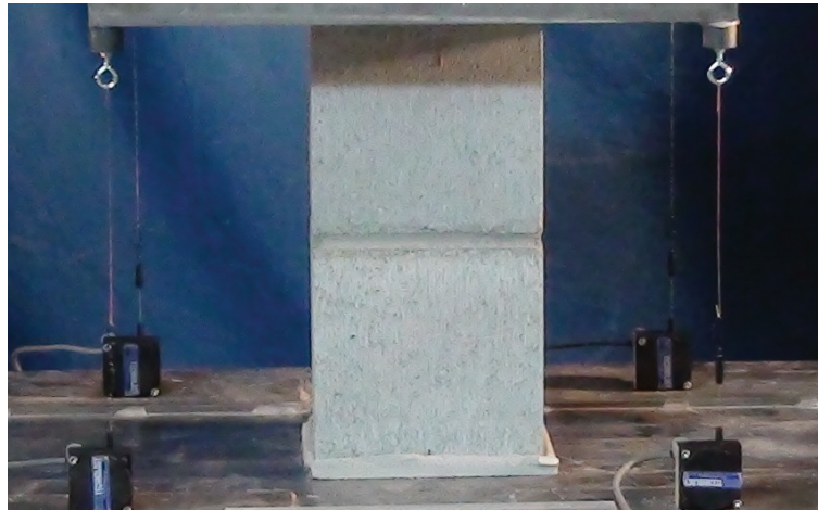
Figure 4.6 – Test de compression sur les murets de deux moitiés de bloc
