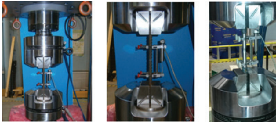
Figure 4.12 – Test de traction sur les barres d'armatures
