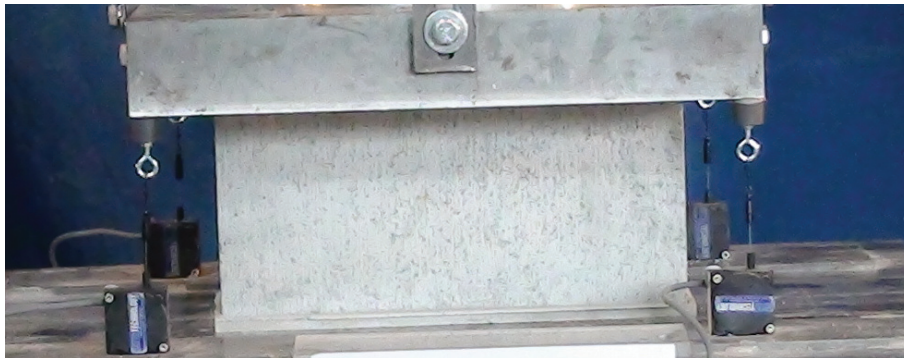
Figure 4.4 – Test de compression sur les unités de bloc
