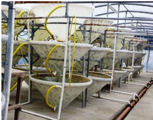
Figura 8 Schiodatoio sperimentale realizzato nell'ambito del progetto " ResUrch " per la sostenibilità ambientale dell'allevamento e il ripopolamento del Riccio di mare in Sardegna (Fonte: Internet).
