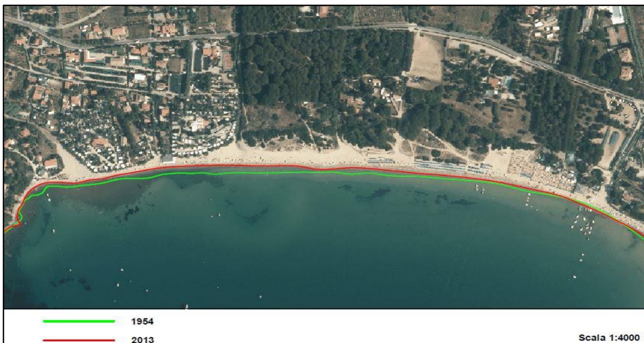
Figura 36 – Evoluzione della linea di costa: in verde la linea di riva del 1954, in rosso quella del 2013.
