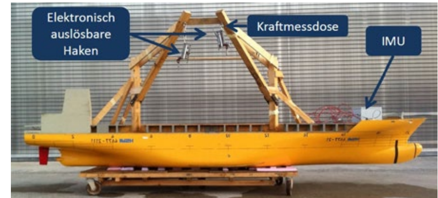
Abbildung 8 : Schiffsdodell für die Versuche mit abreißender Kranlast
