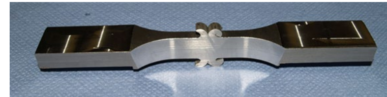
Abbildung 21: Reibschweißprobe mit Wulst
