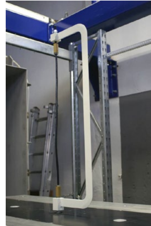
Abbildung 8: Messrahmen mit eingespanntem Musterkabel im Windkanal
