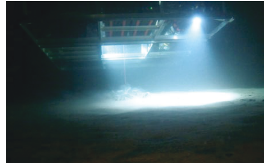
Abbildung 7: Bodenstation kurz vor dem Aufsetzen am Grund des Bodensees (Quelle: Universität Rostock)
