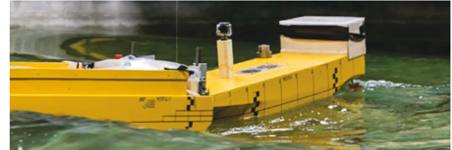
Abbildung 7: Exemplarisches Foto des Schubverbands im Maßstab 1:20.
