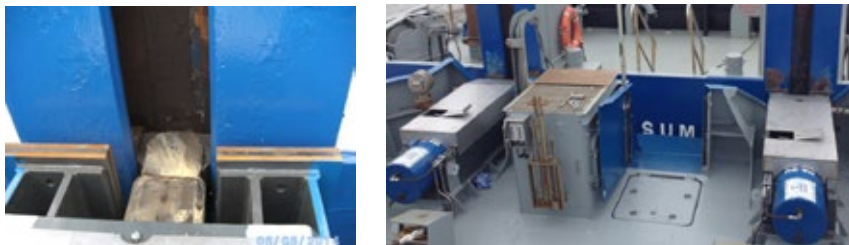
Abbildung 5: Fotos der Kupplung und der an Deck des Schub-Schleppers installierten Kupplungen (Gebrauchsmuster Nr. 20 2013 005 213.9 der HEINRICH HARBISCH Schiffswerft GmbH).
