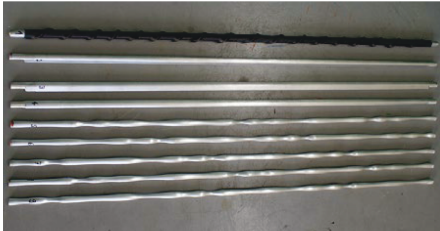
Abbildung 9: Prüfstäbe zur Vermessung der Optimierung von Kabeloberflächengeometrien.
