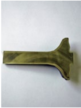
Abbildung 10: Explosivplattierter Grundkörper für ein Schiffsdieselmotor-Ventil
