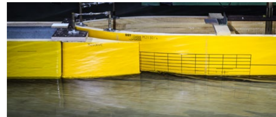
Abbildung 4: Die Koppelstelle im Modellmaßstab 1:16 im Schlepptank des DST
