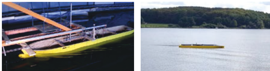
Abbildung 8: Geführter Stoppversuche in der Schlepprinne der SVA (links) und Stoppversuch im Freiland (rechts)
