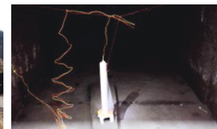
Abbildung 9: Versuchsaufbau, präpariert zum Explosivplattieren von rohrförmigen Bauteilen
