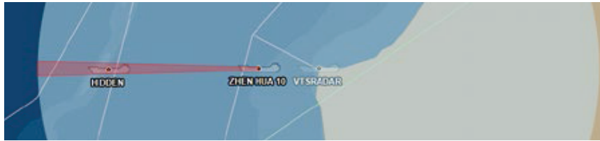
Abbildung 6: Implementierung der Radarschattendarstellung im Signalis VTS.
