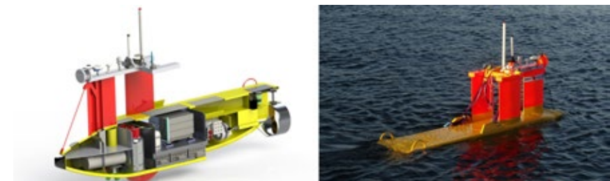
Abbildung 1: Schnittdarstellung des USV (links); Manövrierversuche im Rostocker Hafen (rechts) (Quelle: Universität Rostock)
