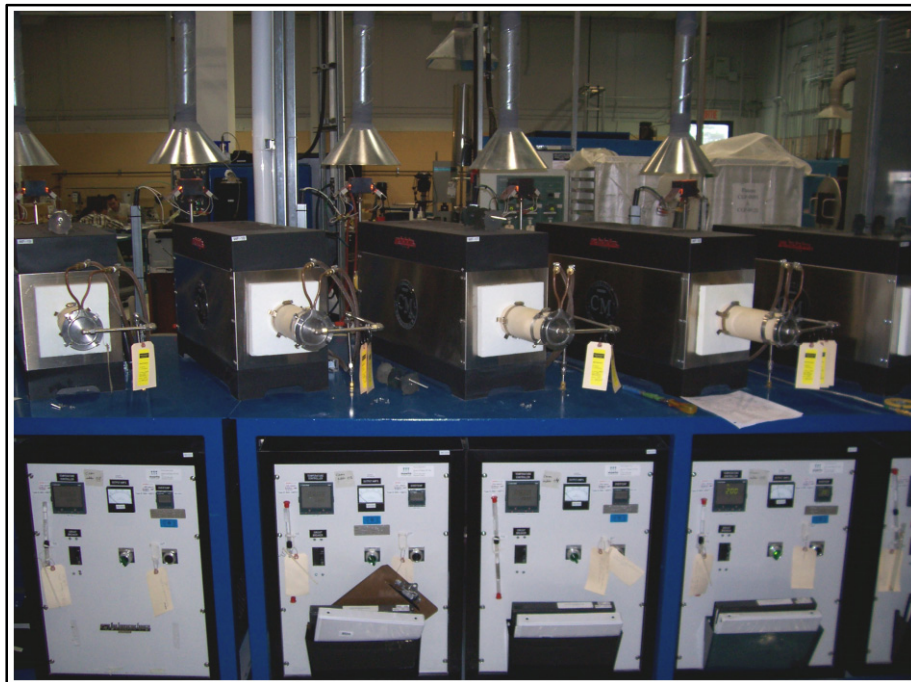
Figure 1.9 Photo des fours de frittage (Ste-Marie, 2009)
