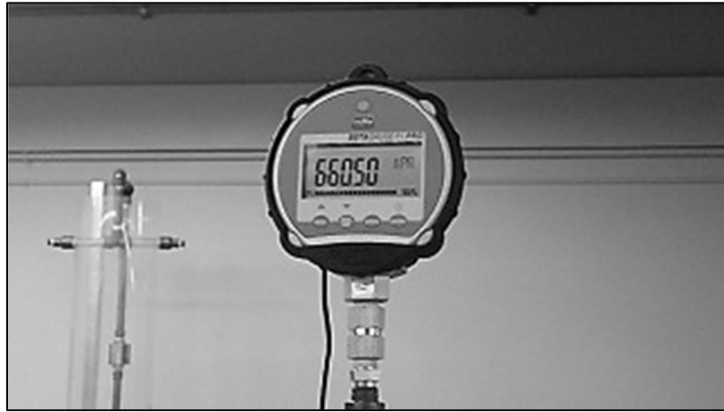
Figure 3.6 Manomètre numérique Beta Gauge P.I.-Pro
