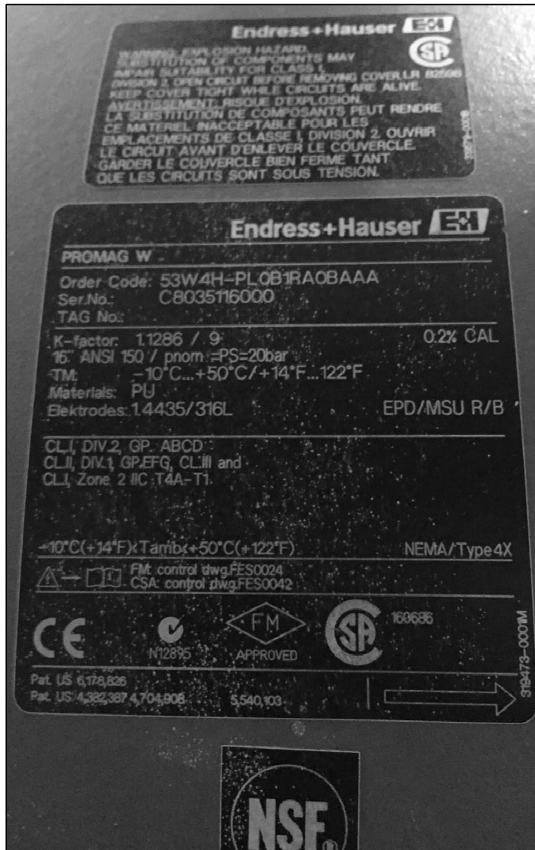
Figure-A II-1 Plaque signalétique du débitmètre Endress+Hauser Promag 53W à l'installation de production d'eau potable
