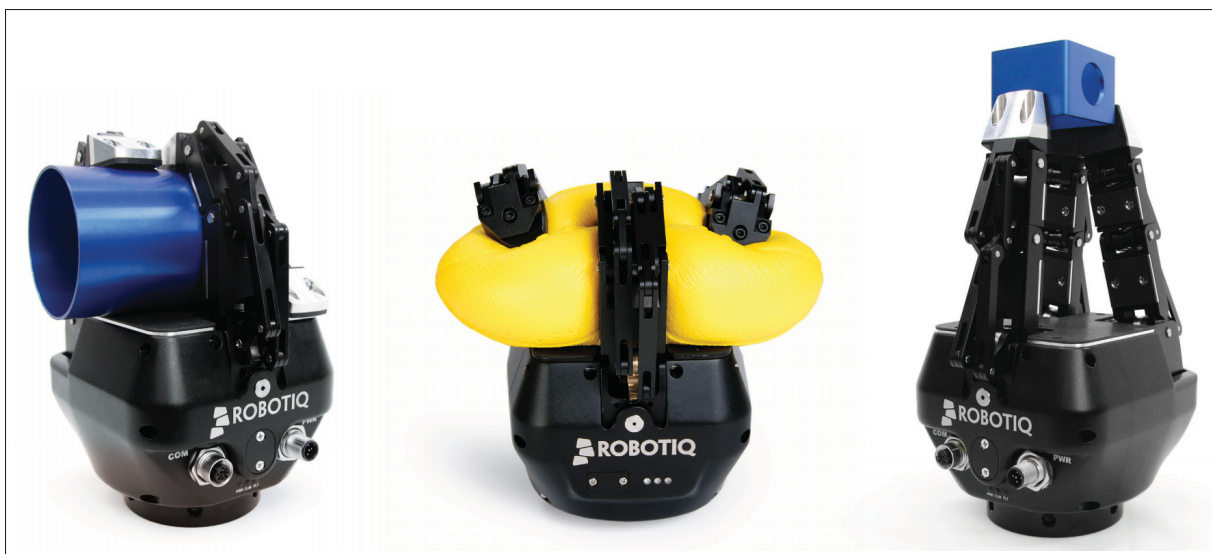
Figure 3.2 Préhensions possibles une main sous-actionnée 3 doigts de Robotiq
