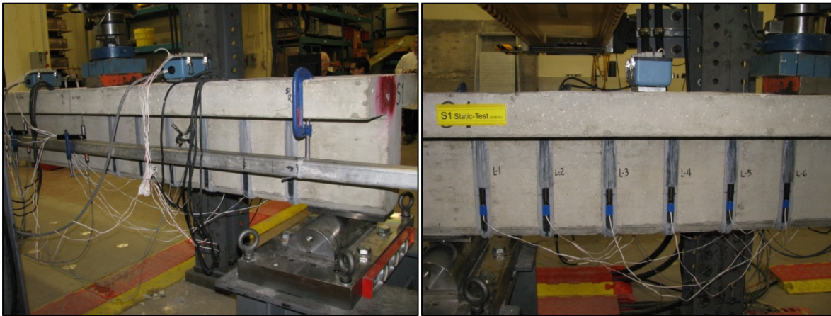
Figure 3. 9 Poutre instrumentée sur le banc d'essai
