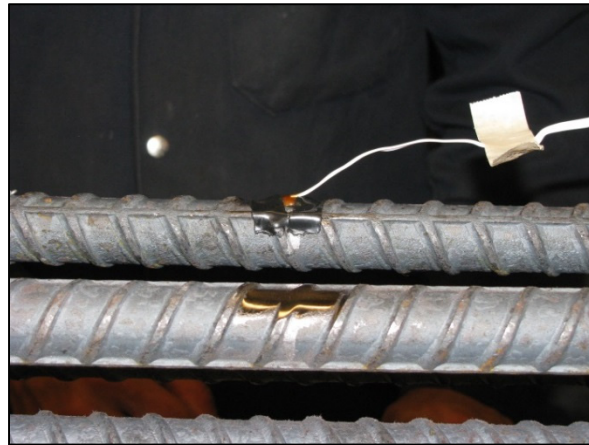
Figure 3. 8 Préparation et installation des jauges de déplacement sur les armatures 25M
