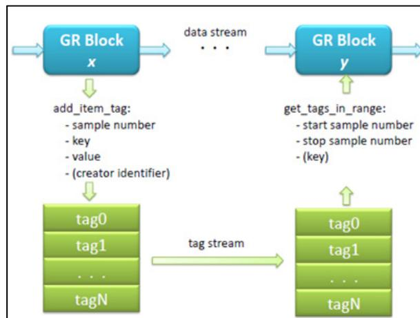
Figure 5.7 Propagation des étiquettes comprenant l'horodatage logiciel [71]
