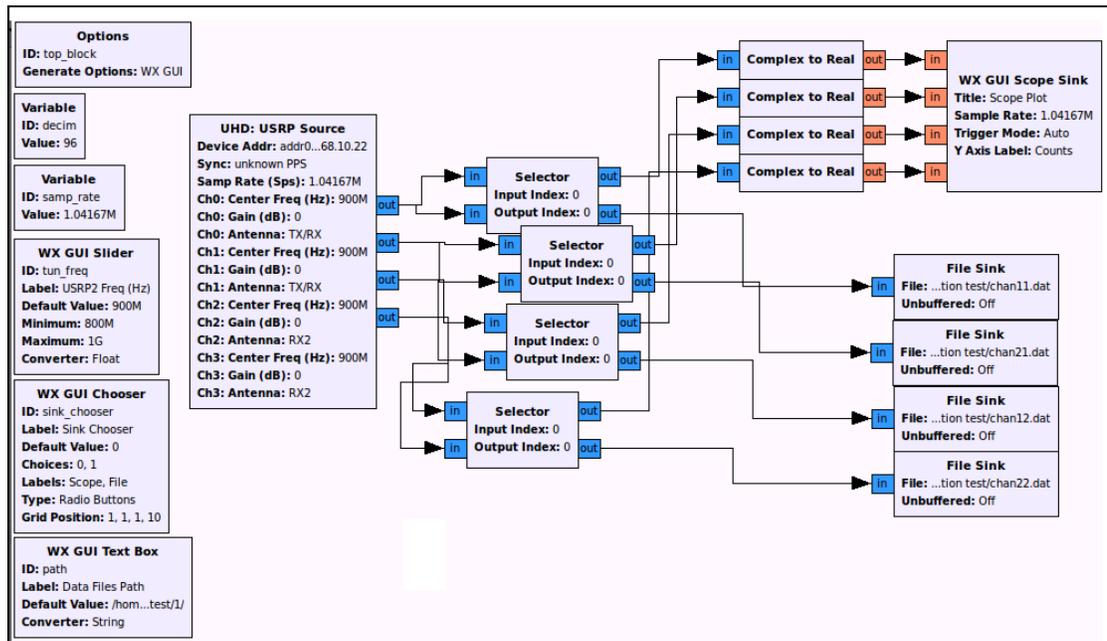
Figure 3.9 Diagramme d'une application GNU-Radio interfacée avec l'USRP
