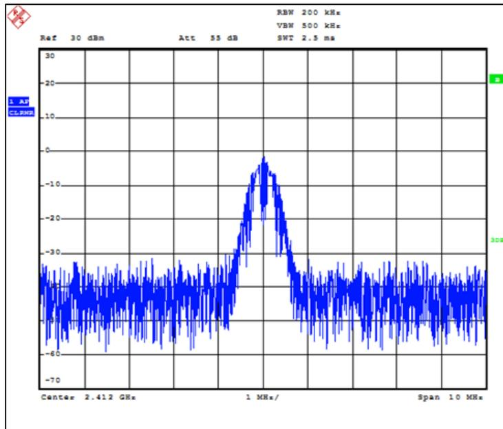
Figure 4.9 Spectre du signal BPSK reçu,  $F_{\text{éch.}} = 25$  MHz
