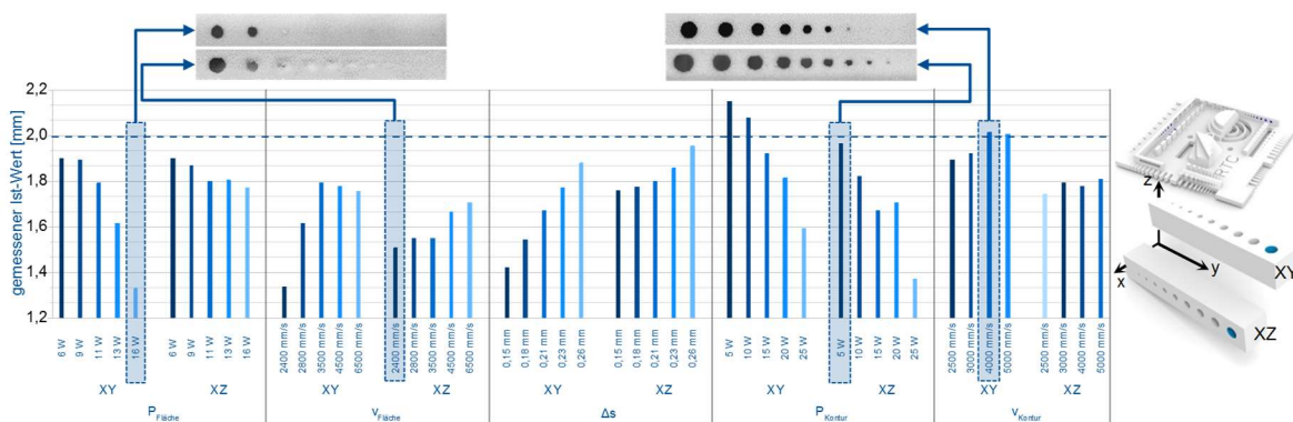
Bild 5-29 - Einfluss ausgewählter Prozessparameter auf Bohrungen
