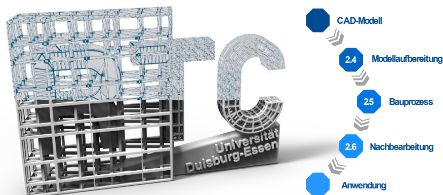
Bild 2-2 - Technologische Prozesskette des Laser-Sinterns
