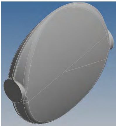
Figure 25 - Géométrie réelle de l'ancienne vanne
