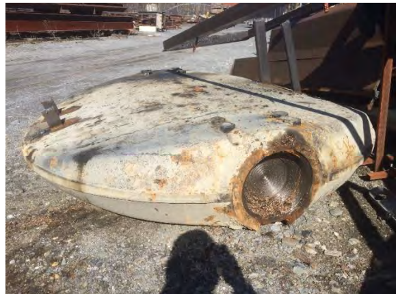
Figure 26 - Photo de l'ancienne vanne démontée
