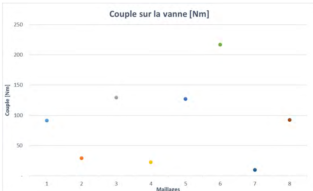
Figure 43 - Couple simulé des maillages testés (ouverture 90°)
