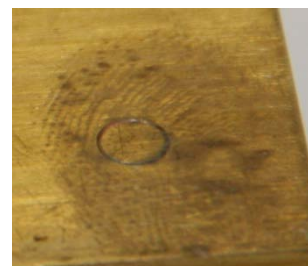
Figure 17 : Corrosion du laiton provoquée par le contact avec la peau.
