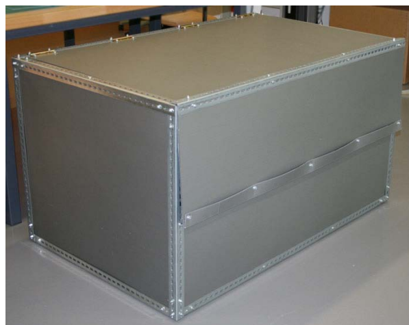
Figure 28 : Caisse de transport à ouverture latérale, en panneaux de PP cannelé fixés sur une structure acier.
