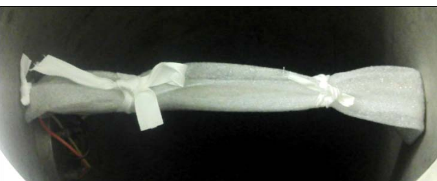
Figure 24 : Tube et fils de PVC emballés dans une mousse de PE fine de 2 mm d'épaisseur, non hermétique.
