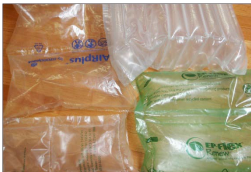
Figure 53 : Coussins d'air de dimensions variables, faits de film de polyéthylène différents.
