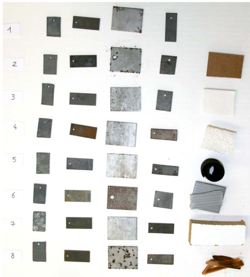
Figure 73 : Résultats du test d'Oddy des plaquettes suspendues. Bocaux N° 1 à 8
