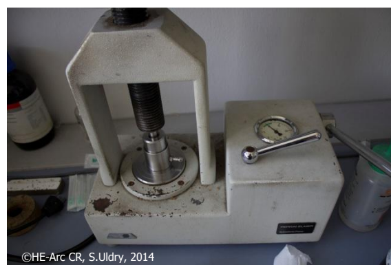
Fig. 8 : presse hydraulique utilisée pour mettre en forme sous pression les pastilles de brochantite
