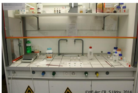
Fig. 14 : application du benzotriazole sous une chapelle ventilée
