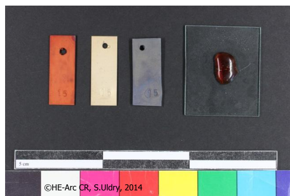
Fig. 64 : Araldite® Fusion sèche sur verre après test
