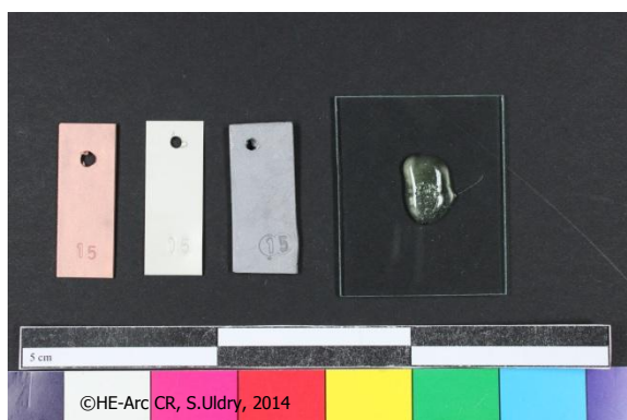
Fig. 63 : Araldite® Fusion sèche sur verre avant test
