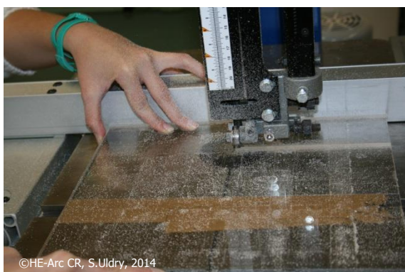
Fig. 18 : découpe de la plaque de Plexiglas®
