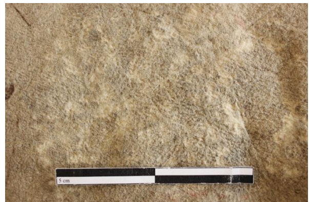
Figure 19 : Usure et formation de « peluches » en surface.
