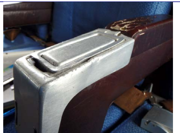
Figure 9 Cendrier avec marques d'enfoncement
