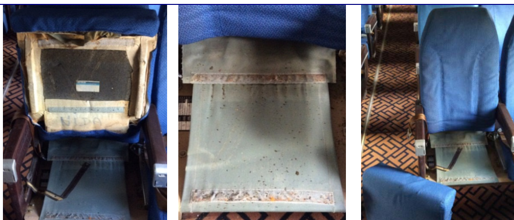
Figure 31 1 ère étape du démontage : retirer l'assise du siège
