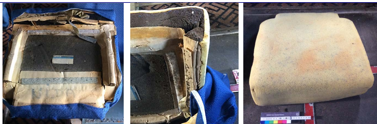
Figure 32 2 ème étape : retirer la housse de l'assise
