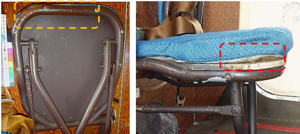
Figure 23 Ossature de l'assise corrodée et perte d'adhérence du velcro
