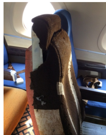
Figure 28 Délitement de la mousse entraînant d'importantes zones lacunaires
