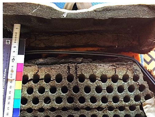
Figure 24 Le joint en caoutchouc peut être à l'origine de la dégradation avancée de la mousse
