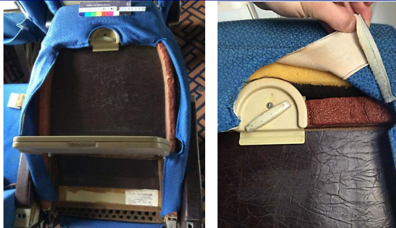
Figure 33 Descendre la tablette pour avoir plus facilement accès aux velcros
