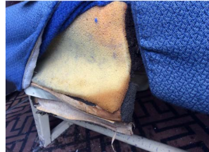
Figure 27 Décoloration et perte des propriétés mécaniques de la mousse
