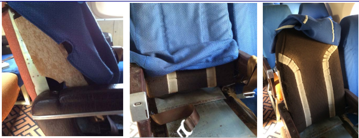
Figure 34 Retirer la housse du dossier en tirant la partie inférieure du coussin vers l'avant
