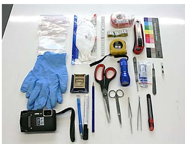
Figure 30 Matériel nécessaire: Gants, sachet PE, masque, mètre, appareil photographique, échelle colorimétrique, étiquettes, cutter, scalpel, pinces, lampe de poche, stylos, marqueurs, loupe, ruban adhésif
