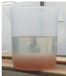
Figuur 4-1 Bezinking elektrocoagulatie, slibniveau na 10 min (25 november, Standaardwater).
