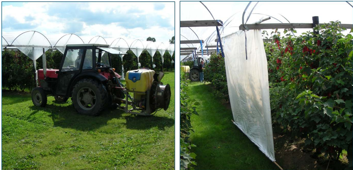
Figuur 2a, b: axiaalspuit voor uitvoering van de proefbespuitingen, en schermen tijdens uitvoering van een bespuiting
