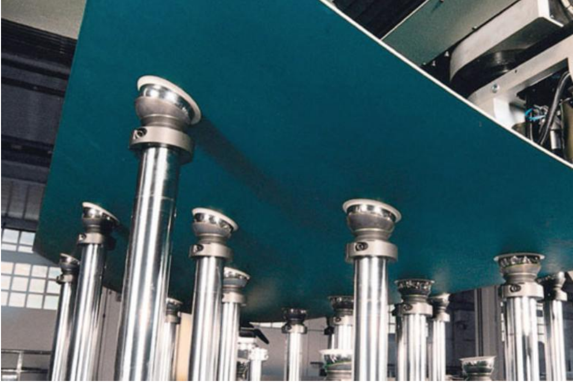
Ilustración 13: Detalle de las copas de vacío del Torrestool
