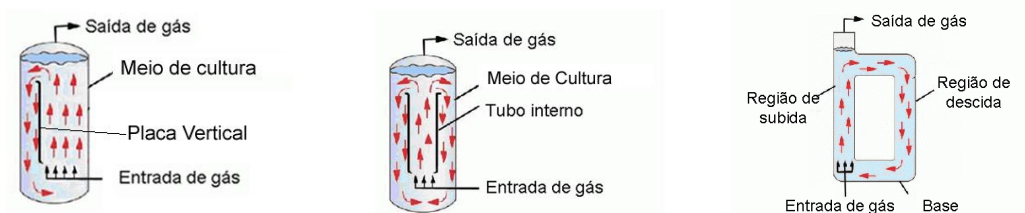
Figura 6.3 - Reatores de arrastamento por gás ascendente a) configuração de cilindro dividido; b) configuração de cilindros concêntricos; c) configuração de circulação externa (adaptado de Cerri (2009)).
