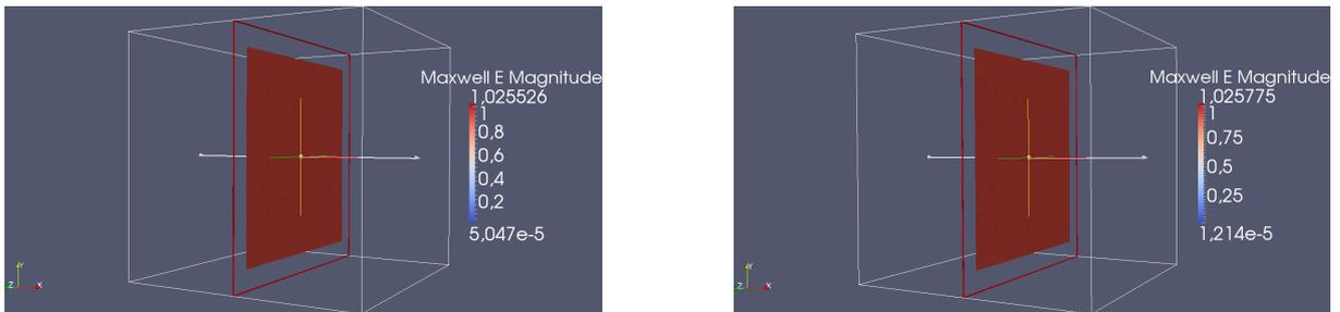
FIGURE 6.53 – Le passage de l’onde à travers la pièce à l’instant  $t = 0.7 \times T$  : la solution asynchrone à gauche et la solution synchrone à droite.
