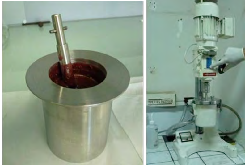
Figure 2-13: Mélange des poudres avec des billes zircone et de l'eau dans la jarre et la machine de broyage-mélange par attrition.
