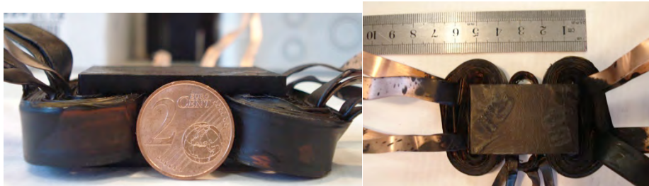
Figure 1-12 : Composant magnétique type LLT utilisant un seul noyau magnétique intégré qui est réalisé au G2ELab [22].
