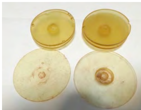
Figure 3-8 : Une série de moules souples de pressage isostatique pour la réalisation d'un noyau torique
