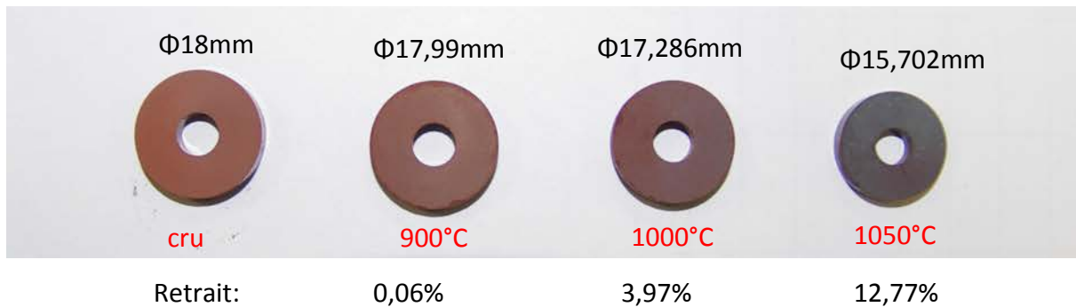
Figure 3-25 : Tores obtenus à différentes températures de frittage
