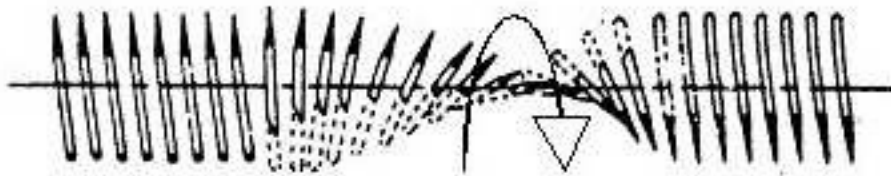
Figure 2-6: Répartition des spins dans une paroi de Bloch
