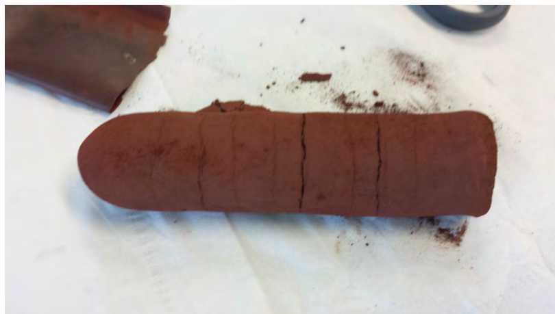
Figure 3-15: Un noyau pressé avec des fissures
