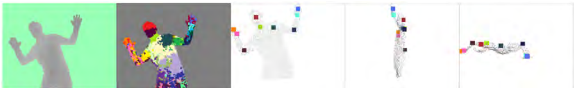
Figure 2-2 : Image de profondeur – Image classifiée en parties du corps – Joints vue de face – Joints vue de côté – joint vue de dessus (Shotton et al. 2011a).
