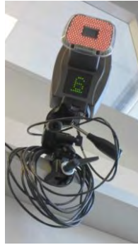
Figure 2-7 : Zoom sur une caméra infrarouge du système MOCAP.
