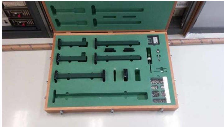
FIGURE 5.10 – Le kit d'étalonnage utilisé pour étalonner l'analyseur de réseau et exciter le guide à métamatériaux PIC.
