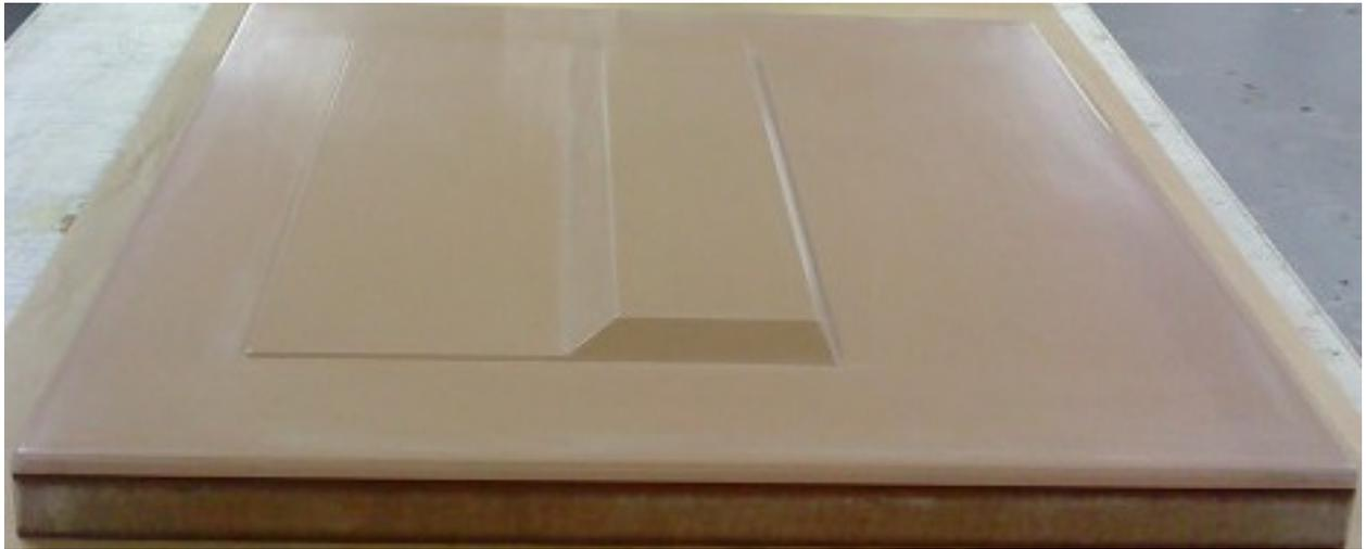
FIGURE 2.14 – Master en résine usinable
