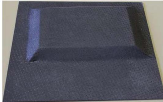
FIGURE 2.10 – Photo du matériau sandwich avec inserts Téflon<sup>®</sup> (peaux de 1.08 mm)
