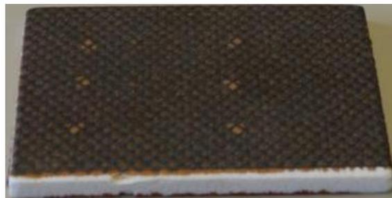
FIGURE 2.7 – Photo du matériau sandwich avec inserts Téflon<sup>®</sup> (peaux de 0.66 mm)
