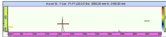
FIGURE 2.28 – Positionnement de la porte A
