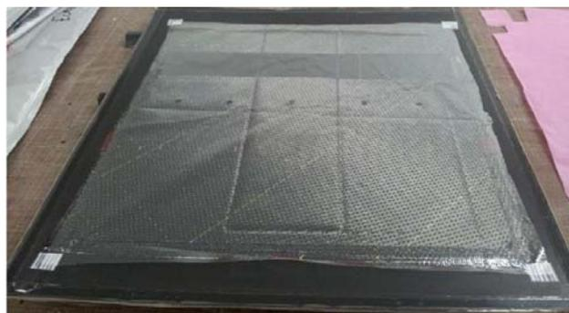
FIGURE 2.18 – Mise en place du film micro perforé
