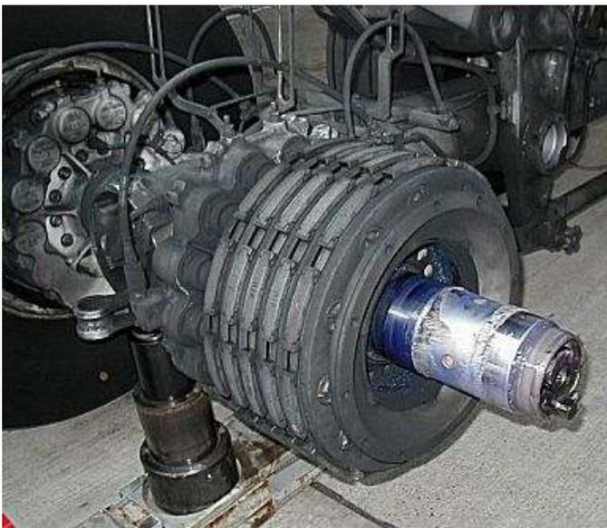
FIG. 1.11: Photo des freins d'un A340
